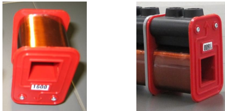
Figura. 3. Bobina utilizada en la que se aprecia que las espiras son más bien cuadradas que circulares.
