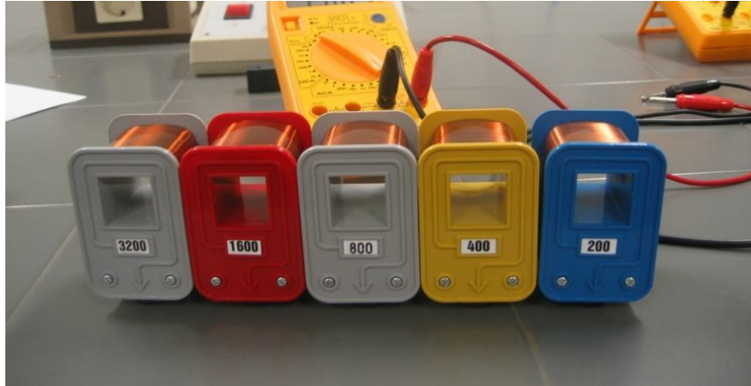
Figura. 2. Las dos bobinas de la izquierda son las que han sido utilizadas en este trabajo. Los números que llevan impresos nos indican las vueltas que tiene cada una.
