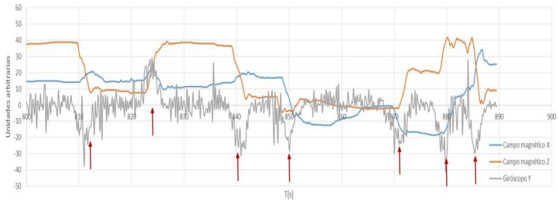
Figura 4. Componentes horizontales X , Z del campo magnético y componente vertical Y del giróscopo. En rojo flechas que señalan los puntos donde el vehículo gira.
