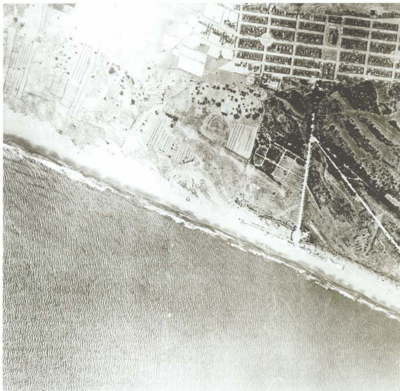
Figura 20. Fotografía aérea de Guardamar tomada en 1930 en la que se aprecia el espacio dunar existente entre el núcleo urbano y el mar. Ya comienza a apreciarse los efectos de la repoblación realizada a principios de siglo para fijar los montículos de arenas móviles que por esas fechas amenazaban con sepultar el pueblo.
