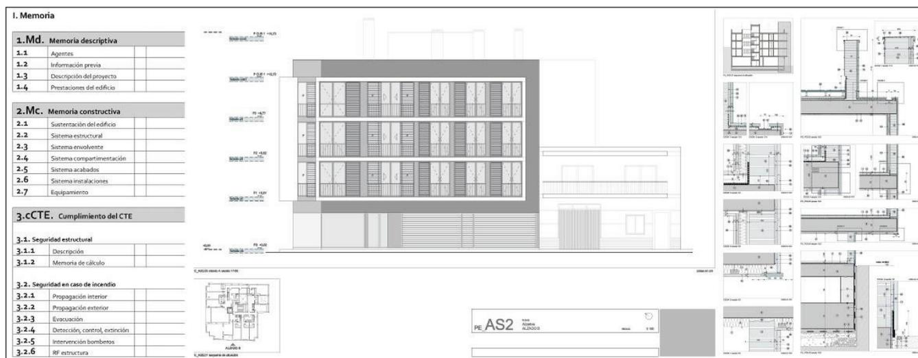
FIGURA 13. Proyecto básico y de ejecución para un edificio de seis viviendas y locales comerciales del año (2008). Imagen izquierda: identificación de distintos documentos que conforman el proyecto. Imagen central: alzado. Imagen derecha: plano de detalles. Fuente: fotografía propia.
