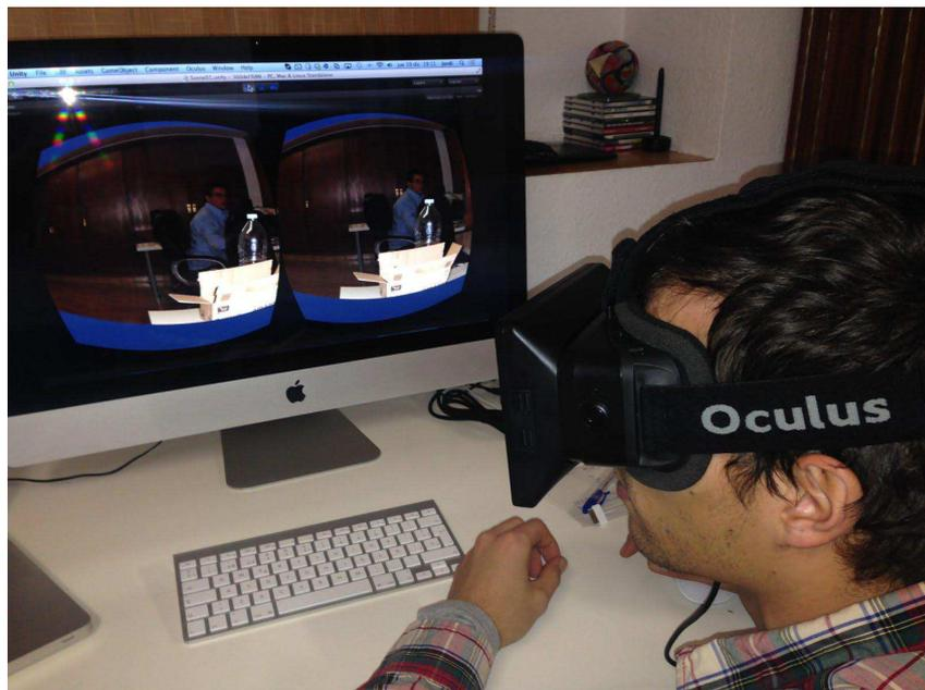
Fig. 3. Ejemplo de un par estereoscópico que se proyecta dentro de las Oculus Rift.
