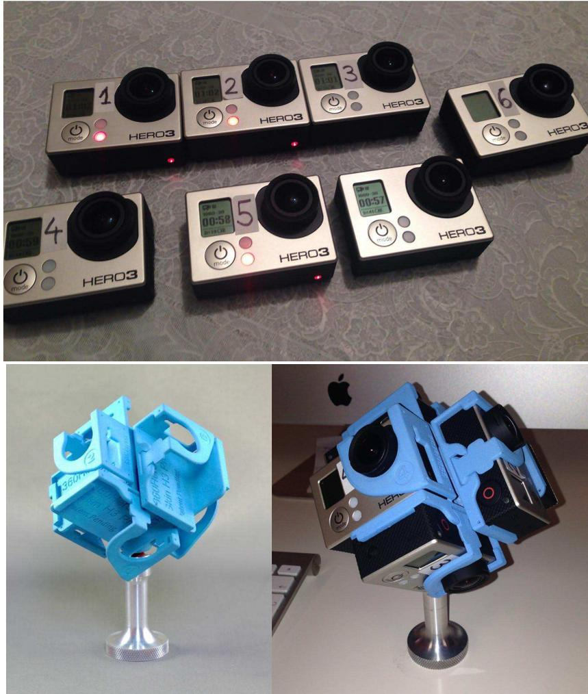
Fig. 1. Grabación de videos 360°; (a) Cámaras GoPro Hero 3; (b) Soporte H3PRO6; (c) Cámaras montadas en el soporte.
