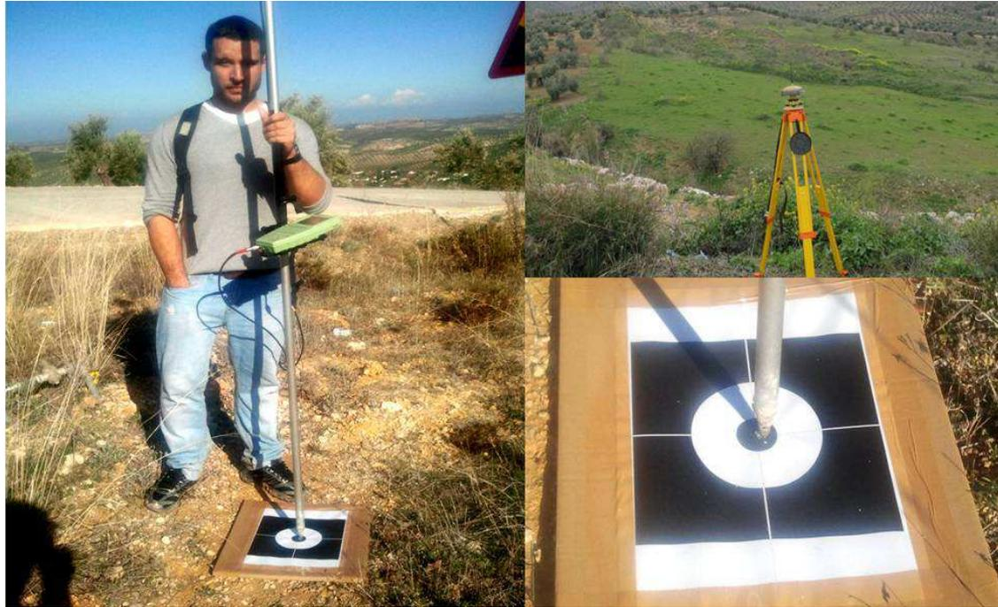
Fig. 4. Medida de los puntos de apoyo mediante posicionamiento GPS
