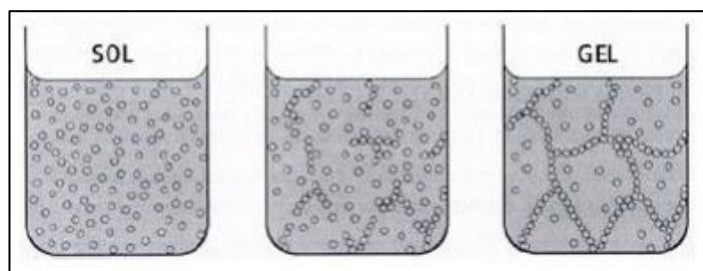
Рисунок 1 – Процесс образования геля из коллоидного раствора
