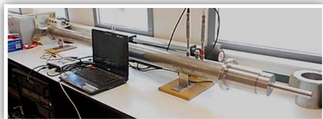
Figura 1. Montaje experimental método de la función de transferencia.
