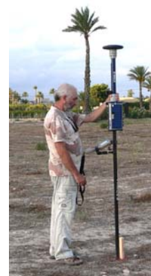
Figura 2 - Unidad móvil del Equipo GPS utilizado para posicionar las estacas en el sistema de coordenadas. Consiste en una pareja de receptores bifrecuencia (Z-Max Thales Navigation, Inc). La precisión horizontal se sitúa en torno a los 2 cm y la vertical alrededor de 4 cm. (Rover of GPS equipment used for to place the stakes for the magnetic sectors).
