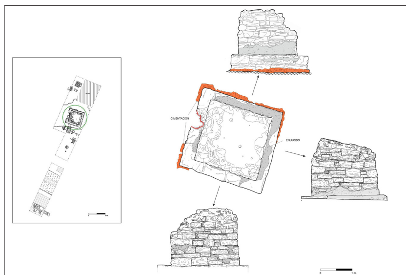
Fig. 5. Planta y alzados del Hornillo de Santa Catalina realizados a partir de Photomodeler .
