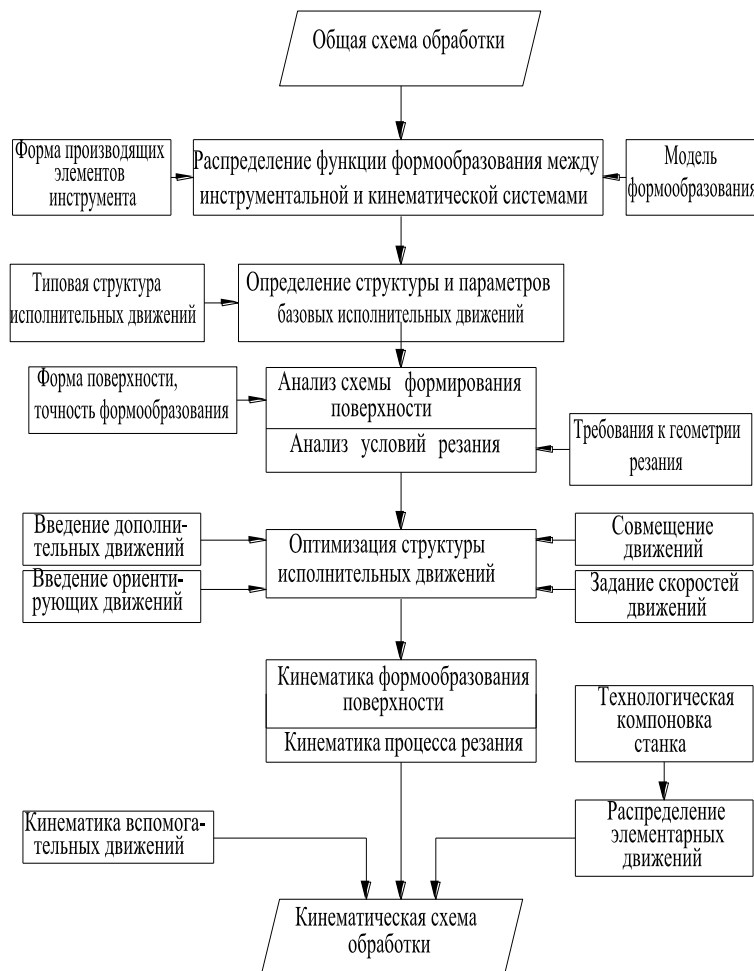
Рис. 2. Алгоритм синтеза кинематической схемы обработки
