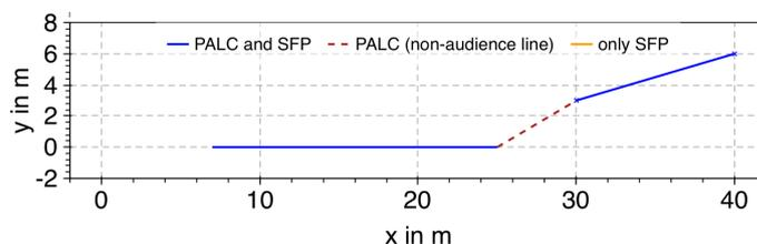
**Abb. 1:** Empfängergeometrie in der vertikalen Abstrahlungsebene mit einer Lücke (rot-gestrichelt, nicht zu beschallender Bereich) zwischen zwei Empfängerlinien (blau). Empfängerlinien, die ausschließlich bei der Schallfeldvorhersage (SFP) auf Grundlage des CDPS-Modells einbezogen werden, sind in diesem Beispiel nicht enthalten.
