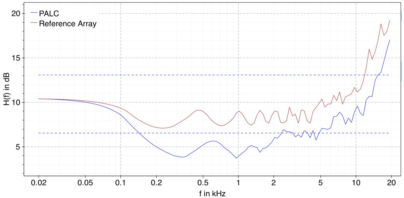
**Abb. 3:** Homogenitätsmaß des PALC-optimierten und des progressiv gekrümmten Referenz-Arrays. Die obere blau-gestrichelte Linie quantifiziert einen optimalen 6-dB-Schalldruckabfall und die untere einen 3-dB-Schalldruckabfall je Entfernungsverdopplung, ausgehend von der Mitte des LSAs.
