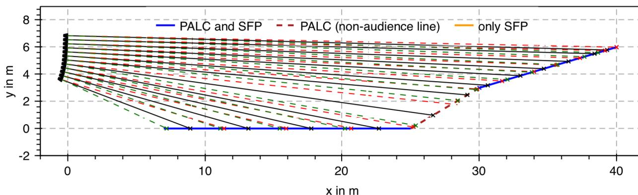
**Abb. 2:** Empfängergerometrie und durch PALC optimiertes, gekrümmtes LSA mit dazugehörigen, iterativ bestimmten Lautsprecheröffnungswinkeln.
