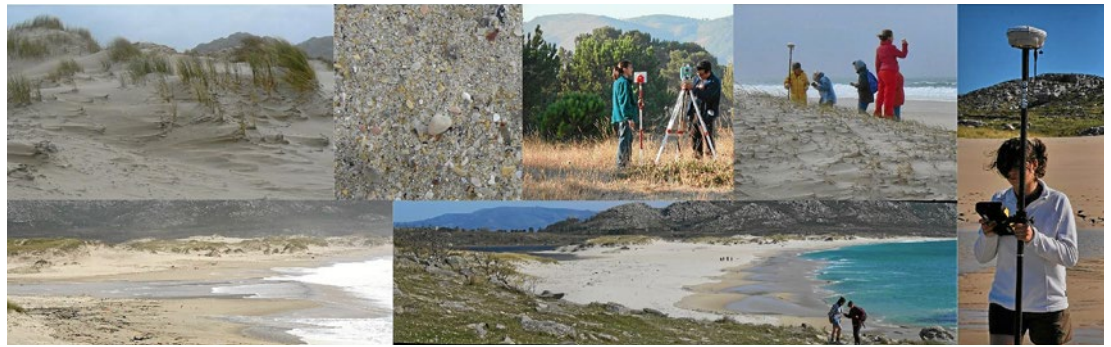
Fig. 3. Algunos aspectos del Complejo sedimentario de Louro. De izquierda a derecha arriba: detalle de cordón dunar; detalle del sedimento de la playa; levantamiento de perfiles topográficos con una estación total, usando un GPS diferencial y detalle de la toma de datos. Abajo: Panorámicas de la playa durante una tormenta y en condiciones de buen tiempo.
