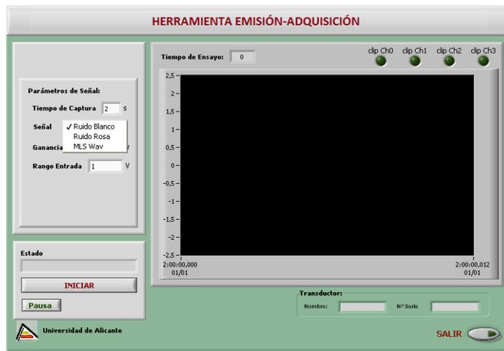
Para la adecuada realización del ensayo, se establecen como parámetros de ajuste el tiempo de captura o adquisición, el tipo de señal a emitir, la amplitud de la señal de salida y el rango de tensión de entrada (éste último permitirá ajustar la resolución de la
