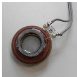
Figura 4. Acelerómetro piezoeléctrico con imán acoplado utilizado como sensor de vibraciones.
