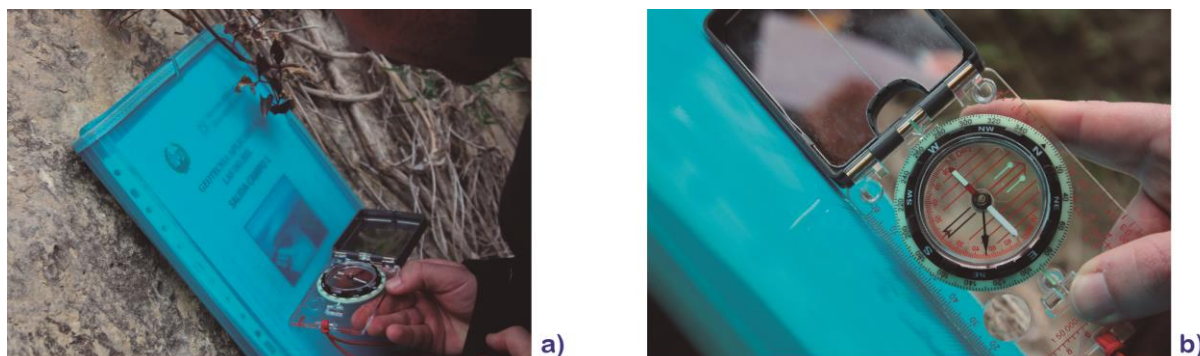
Figura 7. Detalle (diapositiva) del proceso de medición de la dirección de un plano de estratificación (a) y de su buzamiento (b) mediante una animación flash .
