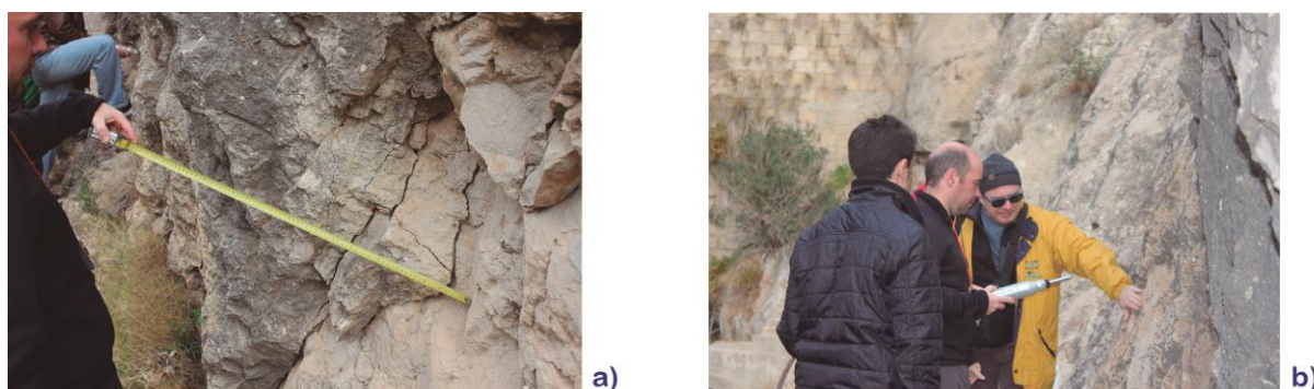
Figura 8. Proceso de medición del espaciado de una familia de discontinuidades (a) y del uso del martillo de Schmidt (b).
