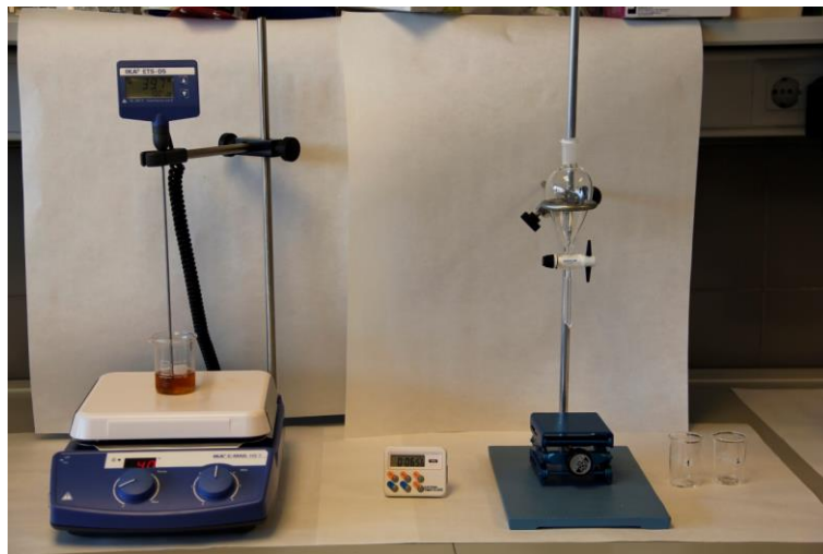
Figura 1. Imagen de la placa-calefactora y del dispositivo elevador utilizados en la práctica.
