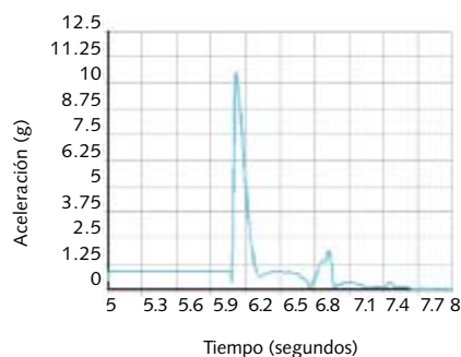
Fig.12: Máxima aceleración del lastre en la simulación con el modelo del ensayo realizado.
