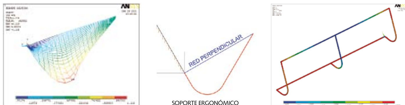
Fig.3: De izquierda a derecha, la deformación de la red, el diseño de los soportes ergonómicos y estos una vez incluidos en el modelo numérico.
