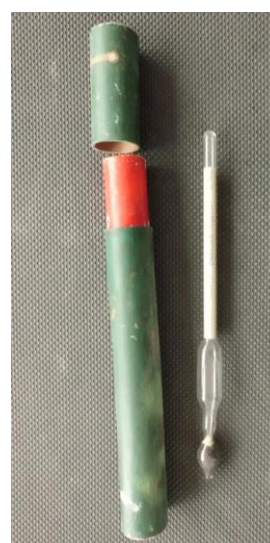
Aerómetro de Beaumé
