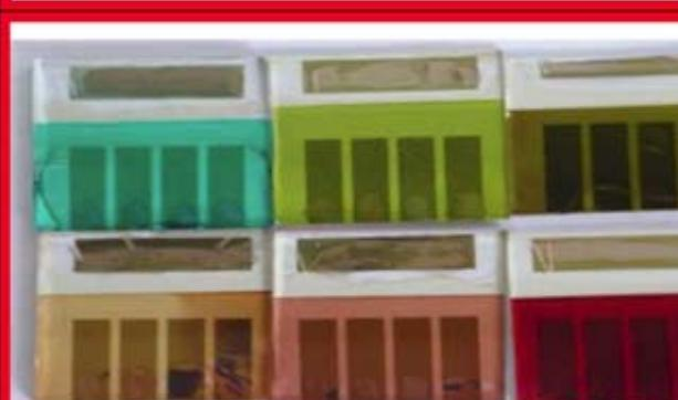
Pannelli solari, a sinistra, e moduli DSC, a destra, in vari colori e substrati.
