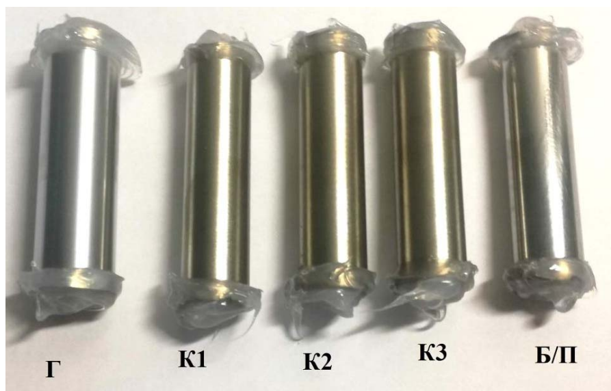
Рисунок 1 – Фото цилиндрических образцов с хромовым покрытием до проведения испытаний на коррозионную стойкость: Г – образец с гальваническим хромовым покрытием; К1, К2, К3 – образцы с хромовыми покрытиями, сформированными методом ЭДПГИ из композитов на основе хрома; Б/П – образец без покрытия
