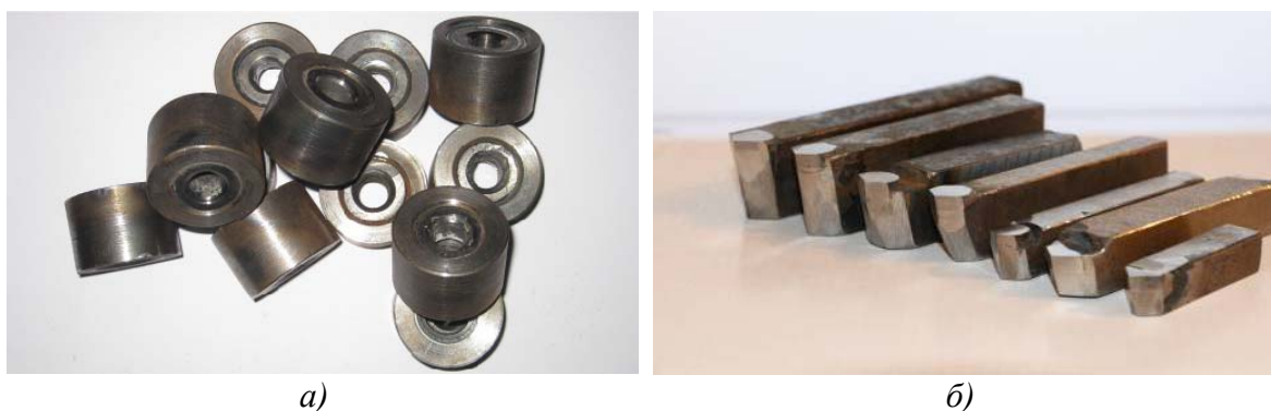
Рисунок 1 – Инструмент из модифицированных порошковых композиций, изготовленный импульсным электроконтактным спеканием: а – фильеры для правки арматурного прутка, б – токарные резцы с режущими экспериментальными вставками
