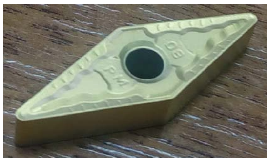
Рисунок 2 – Сменные твердосплавные пластины VNMG 160408
