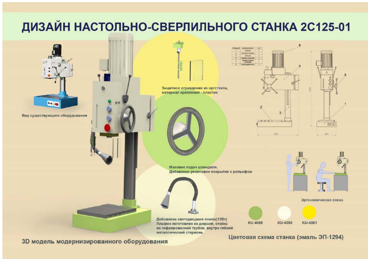
Рисунок 5. - 3D-модель и карта цветофактурного решения сверлильного станка 2С125-01
