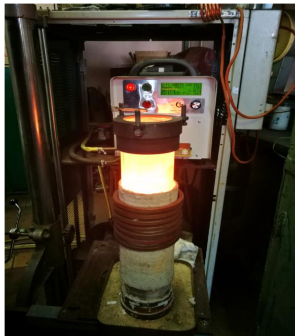
Рисунок 4 – Установка индукционного нагрева УИН-30-8-50
