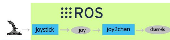
Εικόνα 21. Ροή σημάτων από το joystick στον πίνακα καναλιών
