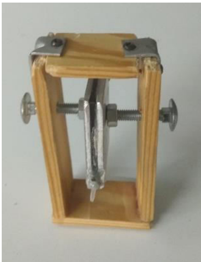
Εικόνα 28. Αυτοσχέδια αγώγιμη κατασκευή συγκράτησης του δοκιμίου.
