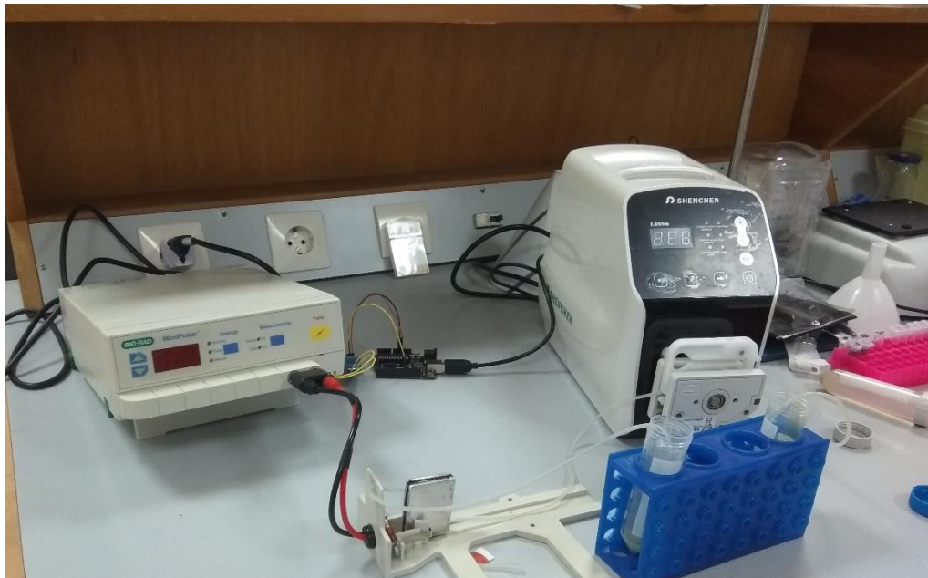
Εικόνα 29. Η ροή του υγρού εντός του δοκιμίου επιτυγχάνεται με την χρήση μιας περισταλτικής αντλίας κι ενός σωλήνα.
