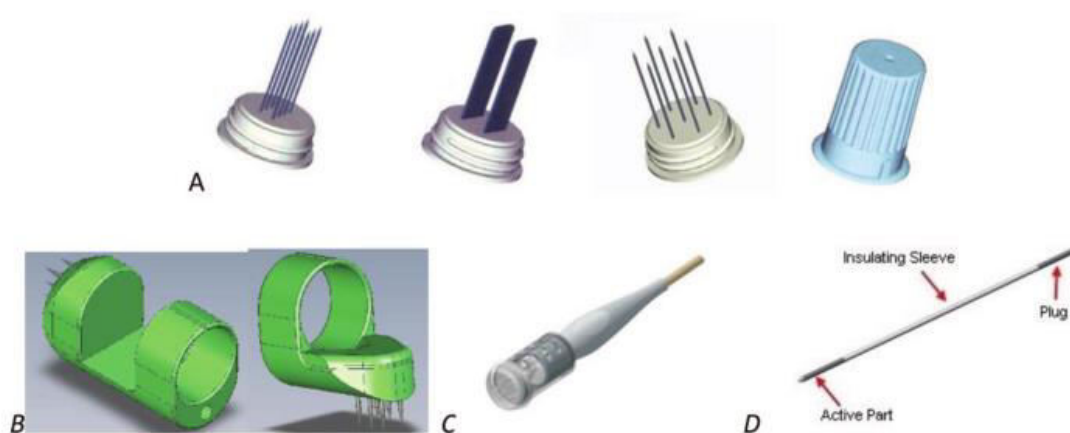
Εικόνα 13. (Α) Ηλεκτρόδια βελόνας και πλάκας που χρησιμοποιούνται στο Cliniporator 2. (Β) Ηλεκτρόδια βελόνας που χρησιμοποιούνται στα δάκτυλα. (C) Μακριά ηλεκτρόδια βελόνας με ρυθμιζόμενα ενεργά μέρη. (D) Ηλεκτρόδιο βελόνας με μονωτικό περίβλημα που χρησιμοποιείται στο Cliniporator VITAE.[20]
