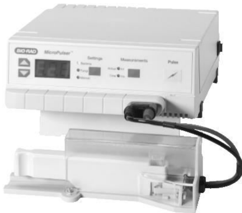
Εικόνα 36. Το σύστημα "MicroPulser" που αποτελείται από μια γεννήτρια παλμών κι έναν δοκιμαστικό θάλαμο, με ενσωματωμένα ηλεκτρόδια [23].
