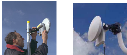
Figura 5.9. Ejemplos de terminales de sistemas de acceso fijo inalámbrico.
