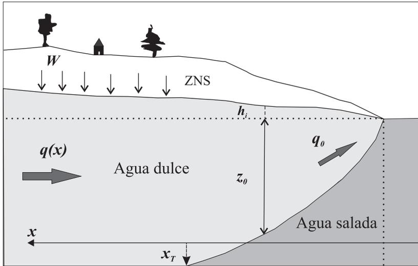
Figura 2. Esquema conceptual del sistema de análisis.
