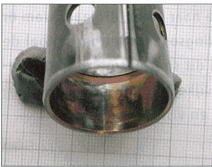
3: lagerbus van de nokkenas van de motorrem met slijtagegebied en oliegroef in het midden.
