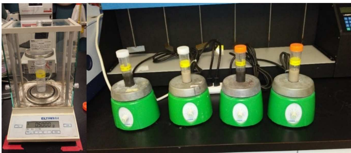
Figure 3.3 Balance de pesage des poudres et tables agitatrices des solutions
