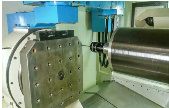
Fig. 1. Probing on a WCBXFZYT machine tool
