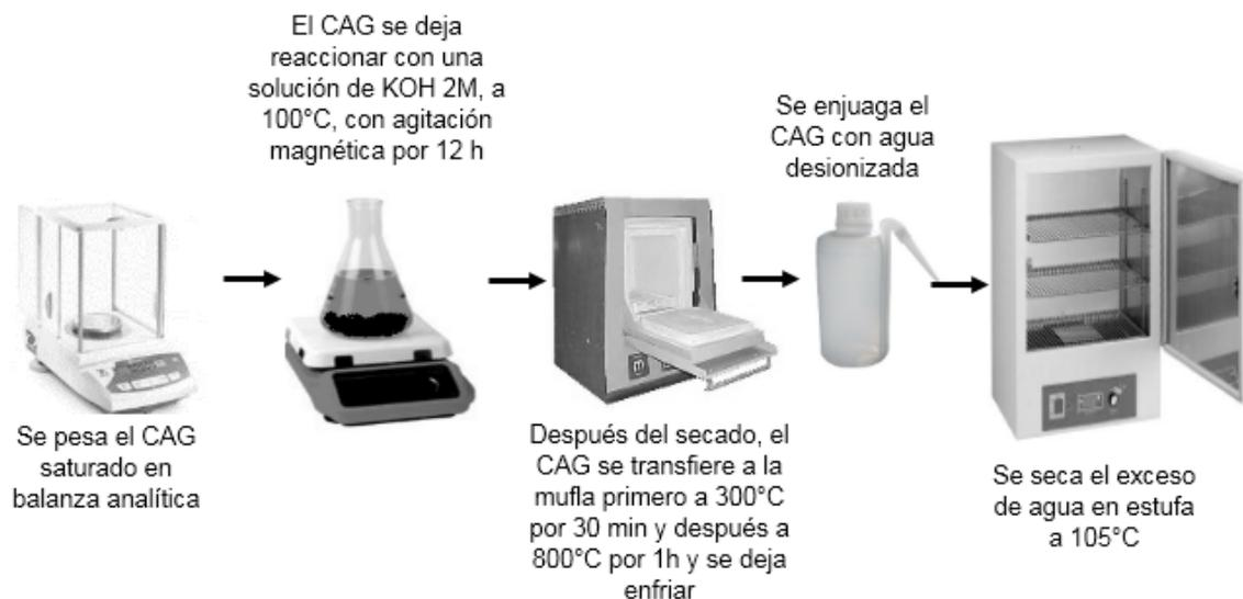
Figura 10. Proceso de regeneración usando Hidróxido de Potasio
