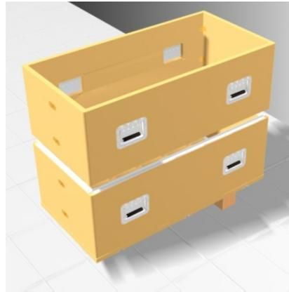
e) Flejado. Un problema con el mantenimiento de los embalajes se da por el constante proceso de flejado de las cajas, ya que comúnmente se utiliza fleje de acero el cual daña el material del que están fabricados los embalajes. Así, pensando en este problema, se colocaron herrajes en la tapa y piso del cajón que permiten que el fleje pase sin dañar la madera del embalaje, además de evitar que los flejes se lleguen a correr con el movimiento.
