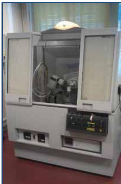
**Figura 6.10** Equipo de difracción de Rayos X (X'Pert Pro PANalytical).
