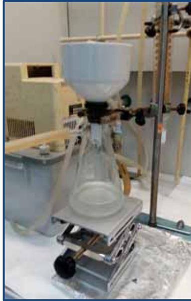
**Figura 6.2** Filtración del gel y lavado con etanol.
