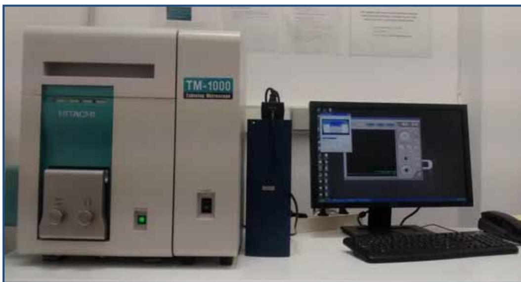
Figura 6.13 Equipo de Microscopía Electrónica de Barrido.
