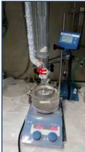
**Figura 6.3** Extracción Soxhlet.
