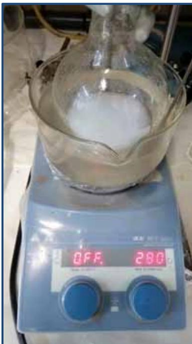
**Figura 6.1** Obtención del gel de alumina dopada con cerio.
