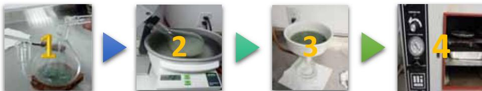
Figura 6. Proceso de acondicionamiento de la zeolita con sodio por intercambio iónico.
