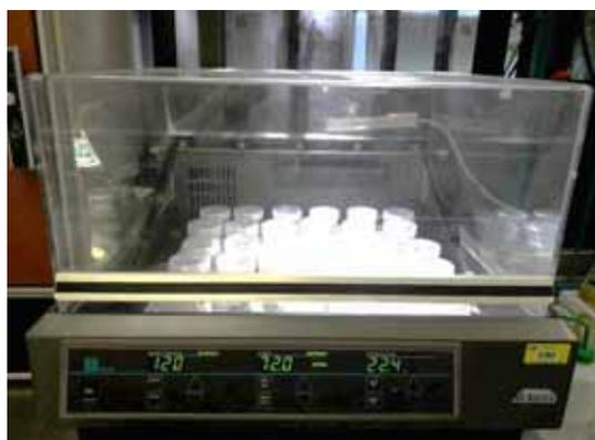
Figura 24. Agitador orbital incubadora: temperatura 22.4 °C; velocidad de agitación 120 rpm; tiempo de 72 h.
