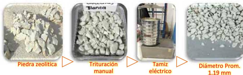
Figura 4. Proceso de trituración y tamizado de la zeolita.
