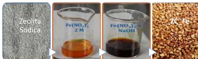
Figura 7. Acondicionamiento con hierro por Impregnación por precipitación.
