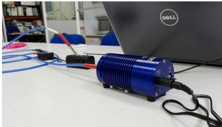
Figura 5.24. de izquierda a derecha: Espectrofotómetro marca Ocean Optics modelo FLAME-S-VIS-NIR-ES, Sensor de reflectancia con base para soportarlo, y lámpara de tungsteno.
