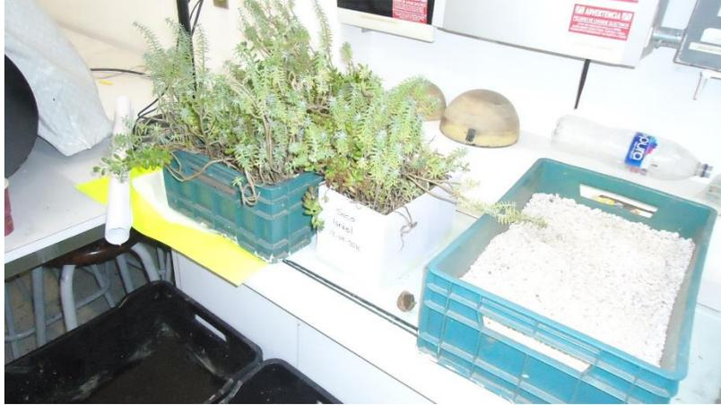
Figura 5.13. Muestra representativa del arreglo de vegetación utilizado para las mediciones. La muestra es la caja de estireno, que corresponde a  $\frac{1}{4}$  de la charola base del sistema de techo verde.
