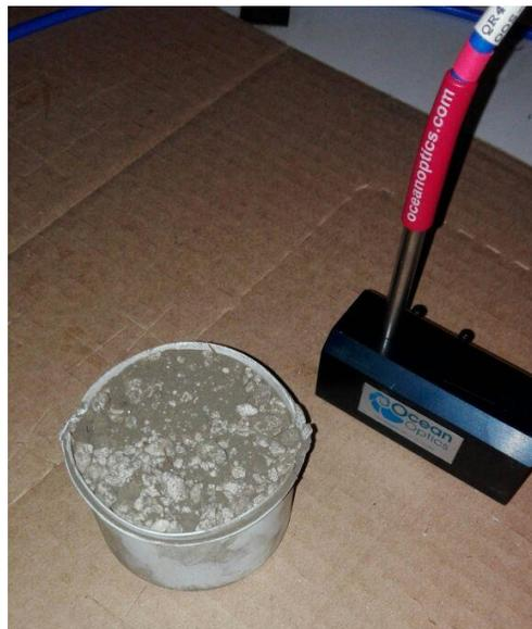
Figura 5.25. Medición de reflectancia del suelo con sensor de reflectancia con base para soportarlo
