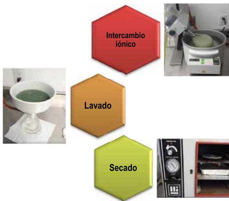
Fig. 5.4 Proceso de intercambio iónico de las zeolitas
