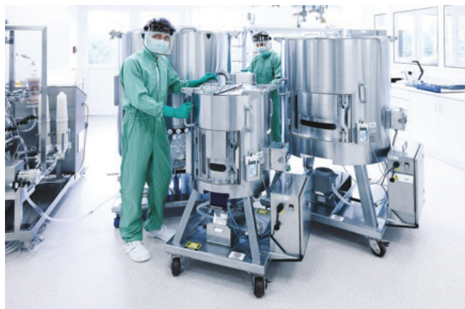
Slika 1 – Bioreaktori u proizvodnom pogonu za bioproizvodnju 1
