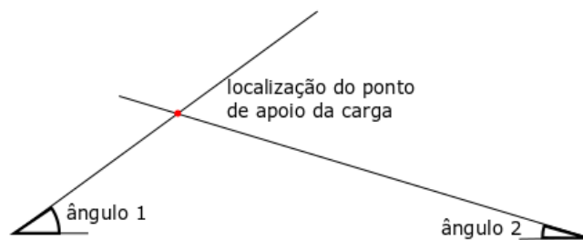
Figura 40 – Esquema representativo do modo de obtenção da posição do ponto de apoio da carga, recorrendo aos dados fornecidos através de cada um dos encoders (ângulo 1 e ângulo 2)
