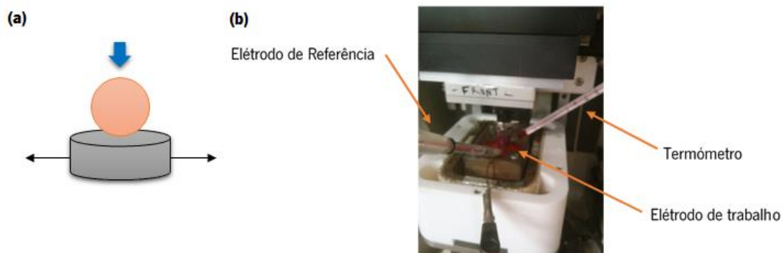
Figura 12: Ensaios de tribocorrosão (a) Esquema do modo de contacto tribológico; (b) Montagem utilizada.
