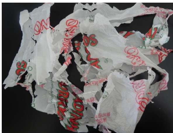
Figura 33 – Sacos em HDPE após trituração
