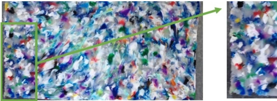
Figura 37 – Material não fundido presente nas extremidades de uma Placa de HDPE
