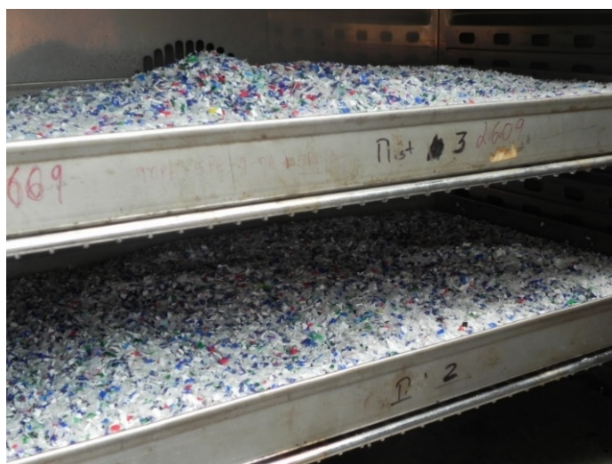
Figura 15 - Secagem de HDPE em Estufa
