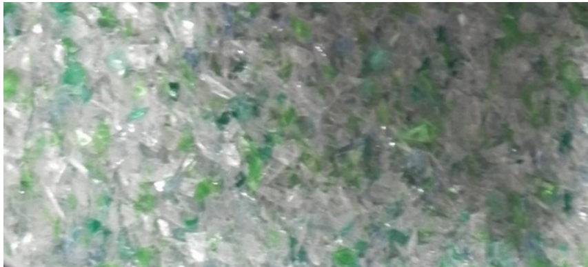
Figura 34 - Resultado de Trituração de PET, granulado com elevada variação de dimensões
