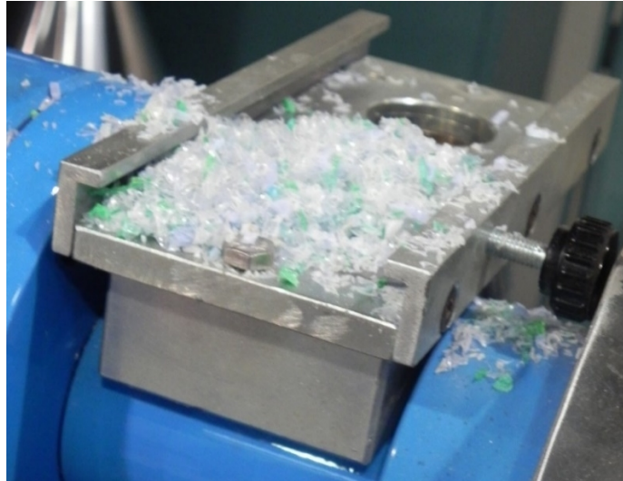
Figura 40 - Alimentação da Extrusora para produção de filamento de PET devido ao baixo peso do triturado
