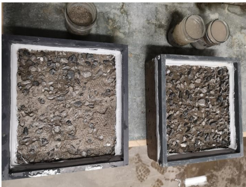
Figure 7-17 : Les échantillons de l'essai de l'écaillage au bout de 25e cycles
