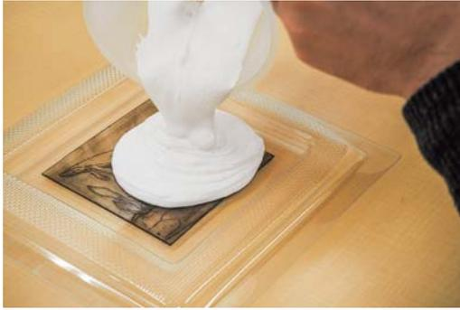
図22 鋳型への石膏の流し込み
