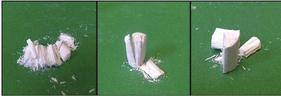
Figura 3 – Imágenes de las piezas de ZSM-5 con bentonita sinterizadas a 900 °C (izquierda), 950 °C (centro) y 1.000 °C (derecha).
