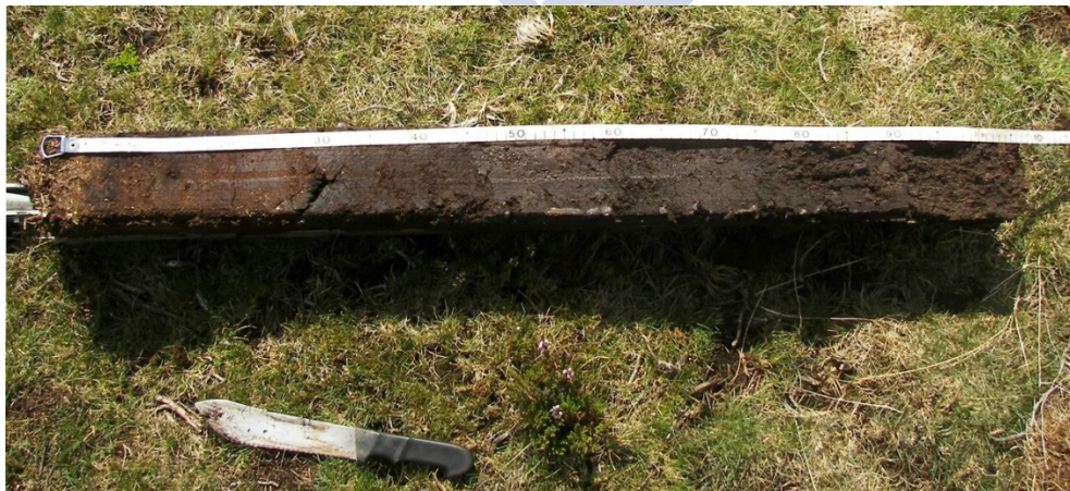
Figura 5.4. Primer metro del testigo de Zalama obtenido mediante una sonda Wardenaar.
