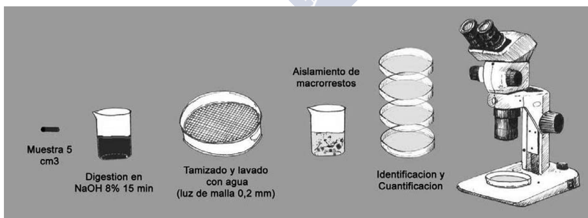
Figura 3.2. Protocolo de extracción de macrofósiles vegetales (Mauquoy et al. , 2010).
