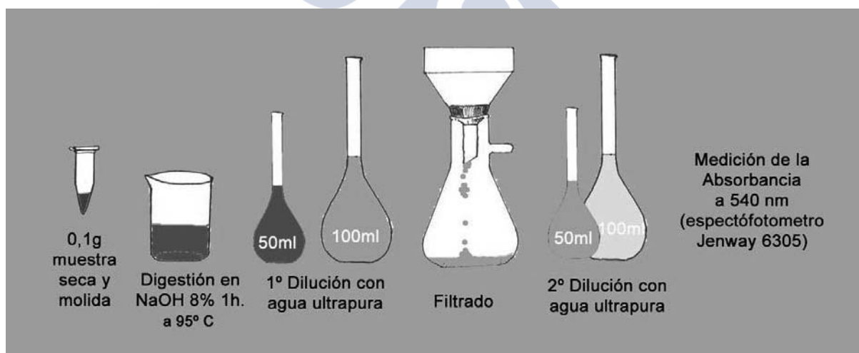
Figura 3.4. Protocolo de extracción de materia húmica (Blackford & Chambers,1993).
