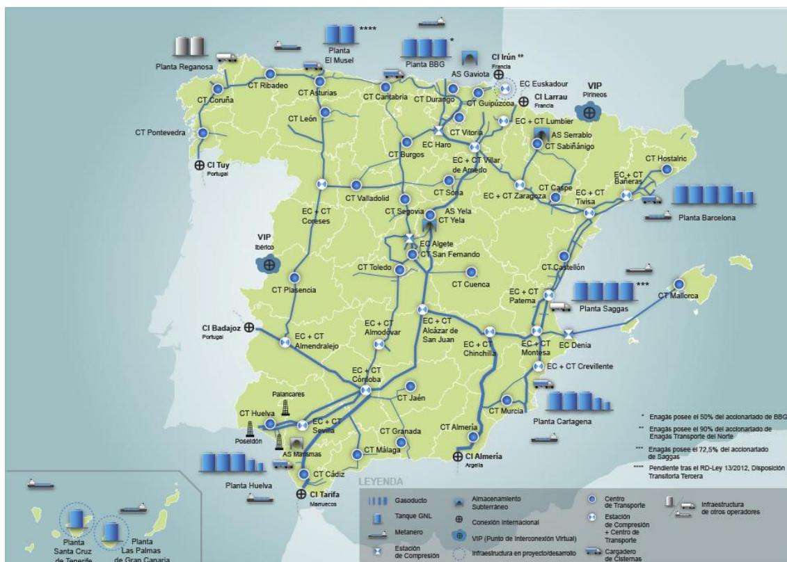
Figura 4. Red de gasoductos en España
