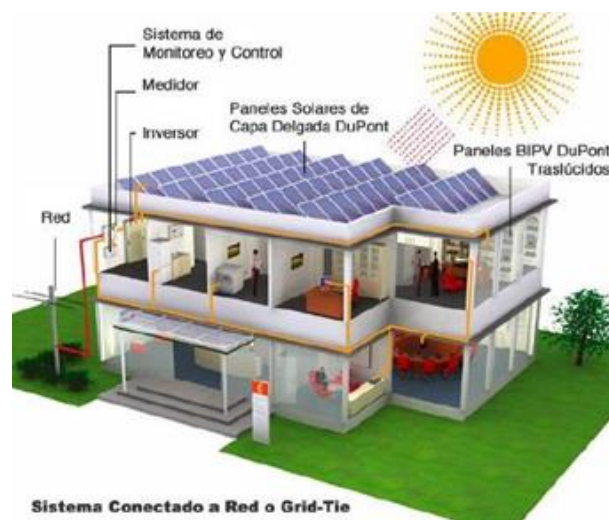
FIGURA 12. ESQUEMA DE UN SFCR. VISION ENERGY.
