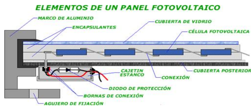
FIGURA 14. ELEMENTOS DEL PANEL SOLAR FOTOVOLTAICO. (Rodríguez L. , 2004)
