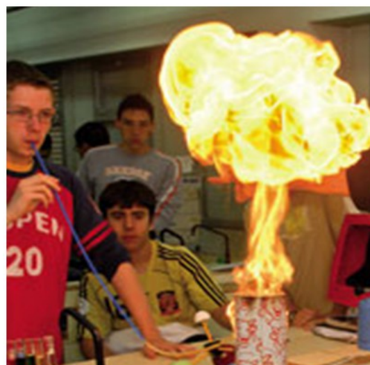
Figura 9. Deflagración del licopodio en suspensión.
