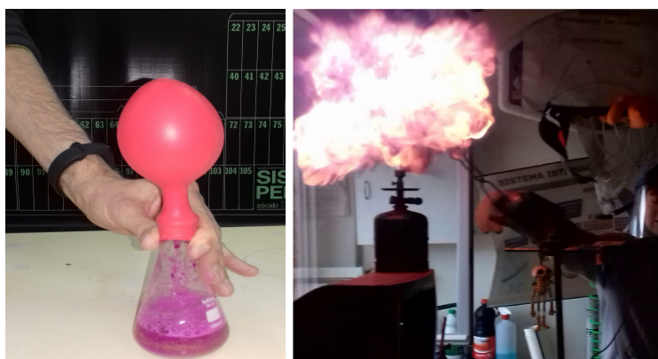
Figura 6. Síntesis y deflagración del acetileno en globo.
