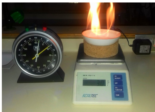
Figura 4. Determinación de la velocidad de combustión del etanol.
