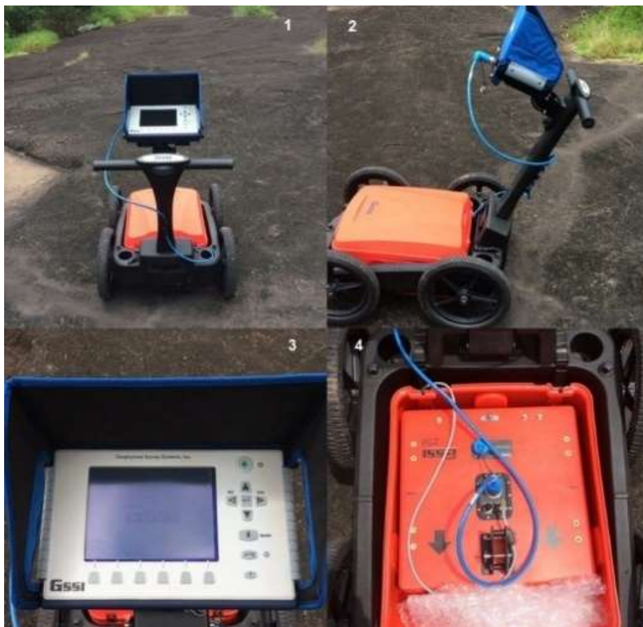
Figura 3. GPR GSSI3000 com a antena de 270MHZ, 1) Equipamento completo, vista do operador; 2) Equipamento em perfil; 3) Unidade de controle; 4) Antena de 270 MHz.
