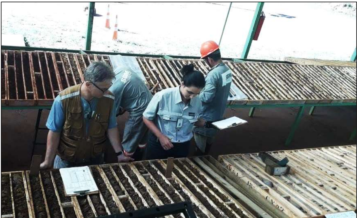
Figura 4. Descrição de testemunhos de sondagem com auxílio do geólogo responsável pela equipe de sondagem da exploração mineral.
