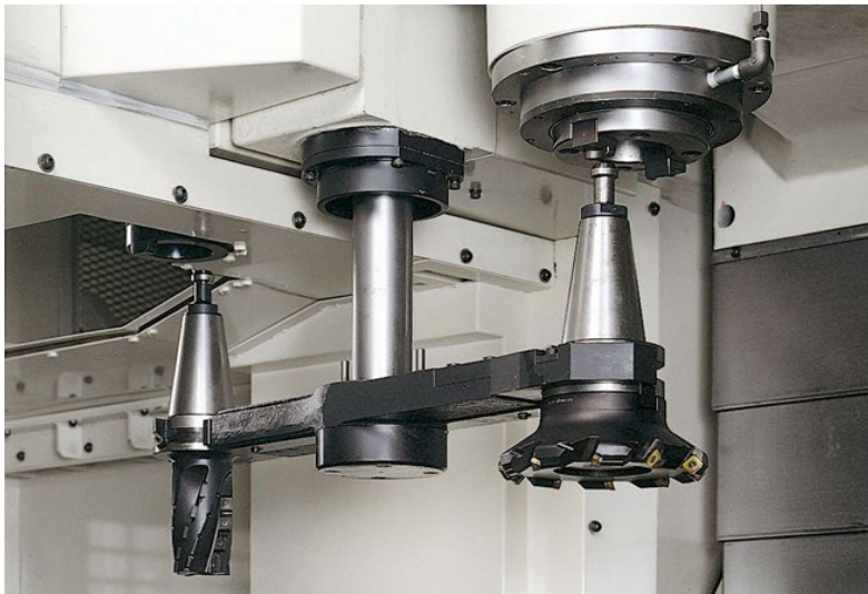
Figura 5 - Pormenor troca de ferramentas automática numa fresadora
