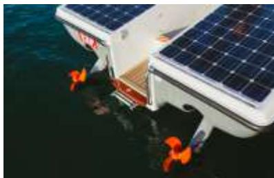
A Sun Concept é uma empresa de construção naval especializada no desenvolvimento e fabricação de embarcações electro solares, apresentando uma eficiência técnica e ambiental superior. Com a aplicação de *designs* industriais em fibra de vidro, esta *start-up* utiliza sistemas propulsores elétricos suportados por bancos de baterias que podem ser alimentados exclusivamente com painéis fotovoltaicos instalados na embarcação.
