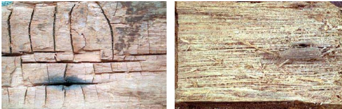
Figura 21 - Ataque de podridão castanha e podridão branca (Coleman, 2003)
