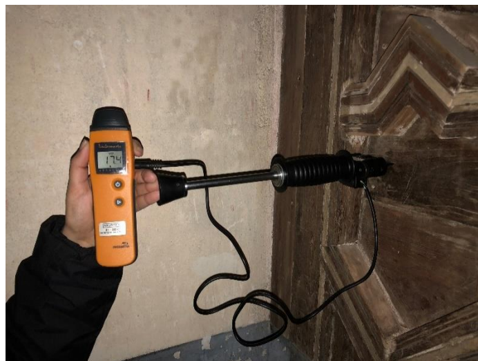
Figura 32 - Medição do teor em água com humidímetro de agulhas
