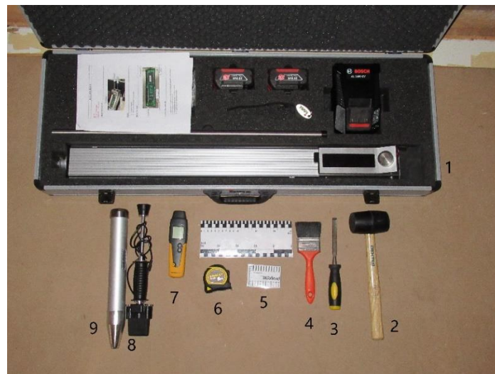
Figura 37 - Material utilizado na inspeção às vigas da tribuna
