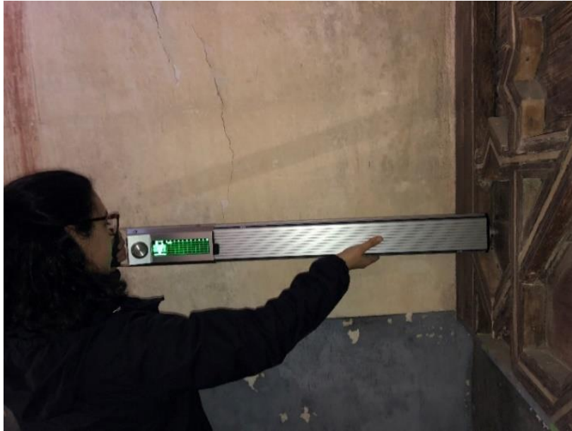
Figura 33 - Realização do ensaio com o resistógrafo
